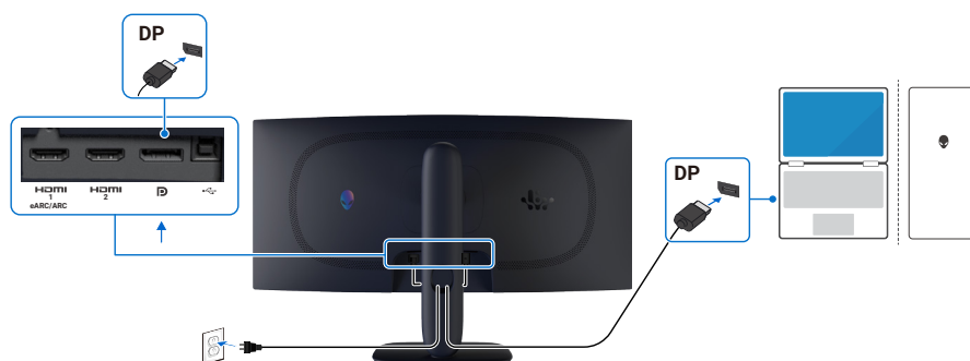
Slika 24. Povezivanje DisplayPort (DP - DP) kabla
