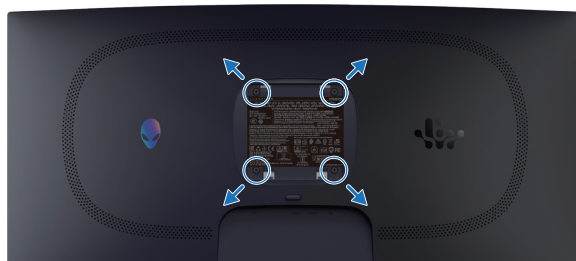
Slika 29. VESA montiranje na zid
