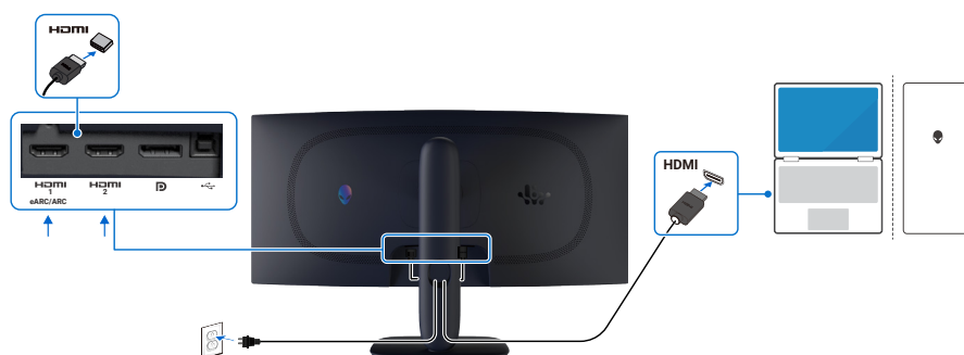
Slika 25. Povezivanje HDMI kabla
