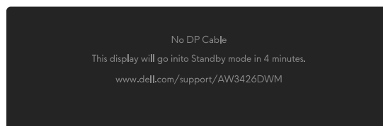
Slika 41. Poruka upozorenja za nedostatak DP kabla
