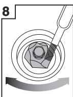
Pulire la macina inferiore con una spazzola per la pulizia
